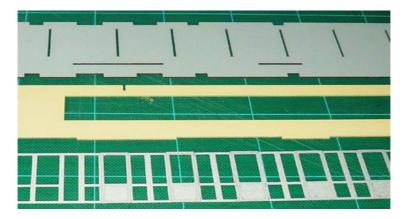
Auf eine Seite des Längswandes wird die Abteilstruktur geklebt.
