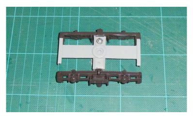
Die Drehgestelle werden mit Metall Radsätze bestückt, (statt mit Kunststoff Räder) und in die Gleilager montiert.
