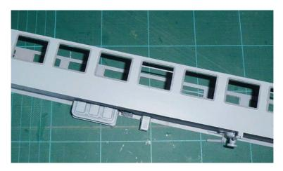
Die Unterseite des Wagens wird Basaltgrau (Ral 7012) gespritzt und, nach trocknen, abgeklebt;
