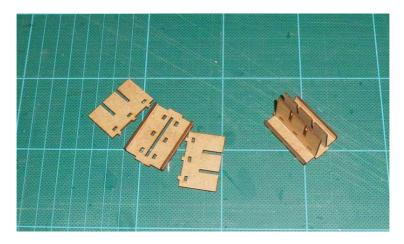
Die beide Sitzflache werden in die Rückenteile geklebt.
