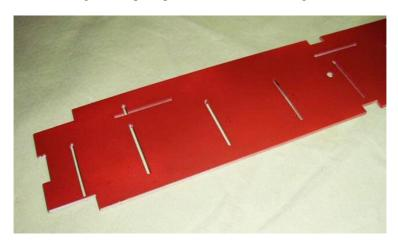
Die Abteil Rahmen, aus Steifkarton 0.5 mm gelasert, werden vorerst Alugrau eingefärbt.
