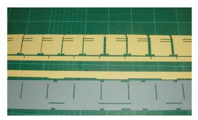
Auch Epochenmassig hat sich die Farbe des Querwändes geändert in Cognacbraun, Beige, Grau, Grunbeige (Ral 1000) etc . Selbstverständlich können diese Teile noch farblich nachgebessert. Fangen wir an mit der Aufbau der Längswand wofür wir die Abteil Strukturwände, der Längswand selbst und die Klarsichtstreife (in gleiche Wanddicke) brauchen.
