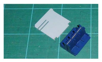
Abteil Wände und die Bodenplatte sind ausgelasert in 1.5 mm MDF. Die Abteilstruktur ist in diesem Fall symetrisch gehalten und ist standard für das 1 Kl Bereich (9 Abteile)
